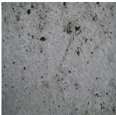
Рис. 2. Макроснимок осевой линии разметки после 3 месяцев эксплуатации на асфальтобетонном покрытии:
