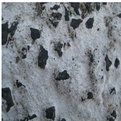
Рис. 2. Макроснимок осевой линии разметки после 3 месяцев эксплуатации на асфальтобетонном покрытии:
