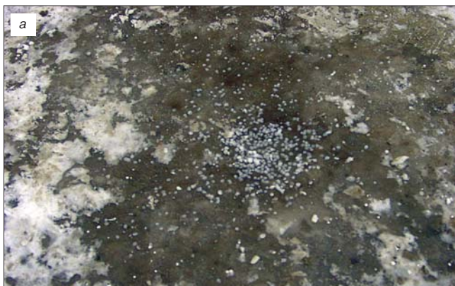
Рис. 4. Испытания хлорида магния: а – непосредственно после его распределения, б – результат плавления снежно-ледяного образования
