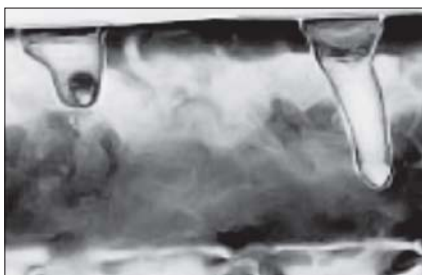
Рис. 5. Проникновение в лед сухого и предварительно смоченного ПГМ
