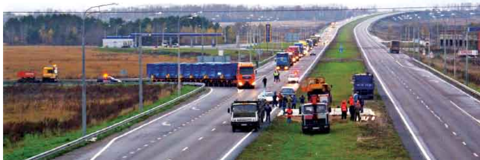
Фото 3. Выезд автотранспортного средства на участок федеральной автомобильной дороги в сопровождении запасного тягача (машина прикрытия)
