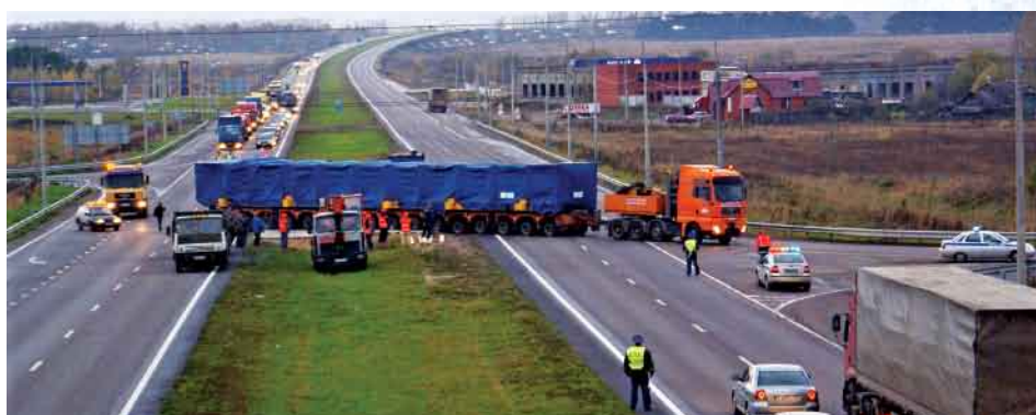
Фото 4. Пересечение автотранспортным средством участка временного усиления; перекрыто встречное движение
